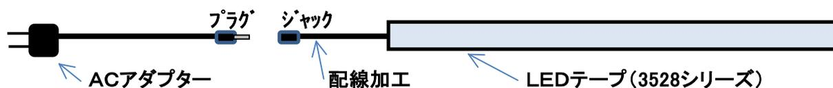
※LEDテープライトは5Mロール単位の製品ですので、長さや数量によっては、端材が発生しますので、基板接合が必要になります。
